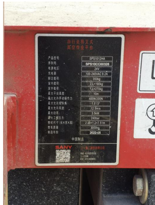
图 3、4 涉事的 SPS1012HA 剪叉式高空作业平台示意图及铭牌照片
