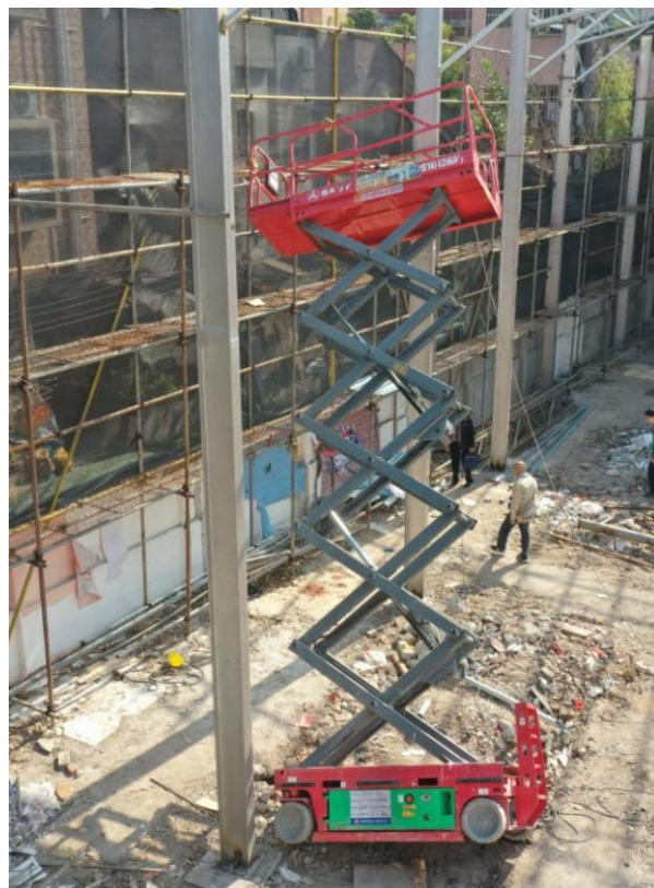
图 8 涉事 SPS1012HA 剪叉式高空作业平台图
