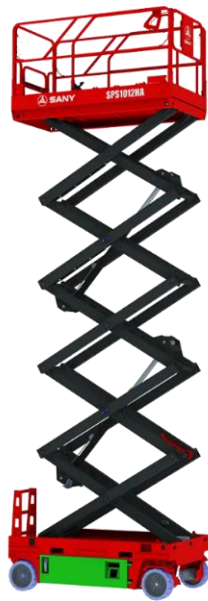
图 3、4 涉事的 SPS1012HA 剪叉式高空作业平台示意图及铭牌照片
