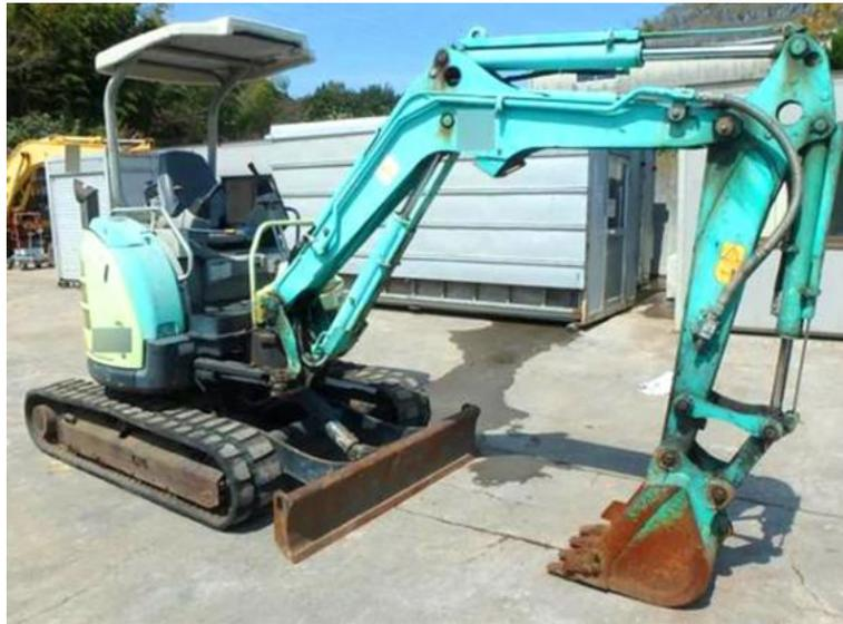
图 2 涉事同款挖掘机（洋马 VI030-5B）样图
